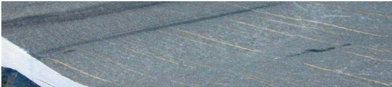
Il porfiroide viene estratto in alta Val Brembana. Da un punto di vista petrografico si tratta di una metarenaria costituita da silicati che gli conferiscono ottime caratteristiche tecniche. Mostra elevati valori di resistenza meccanica. Sono significativi i valori di resistenza a flessione, al gelo e all'usura, che ne fanno un materiale ideale per esterni.
